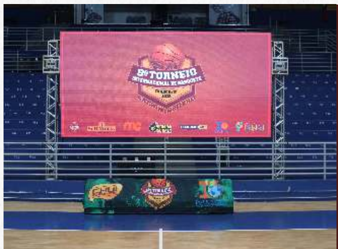
Painel de LED com suporte das treliças.
